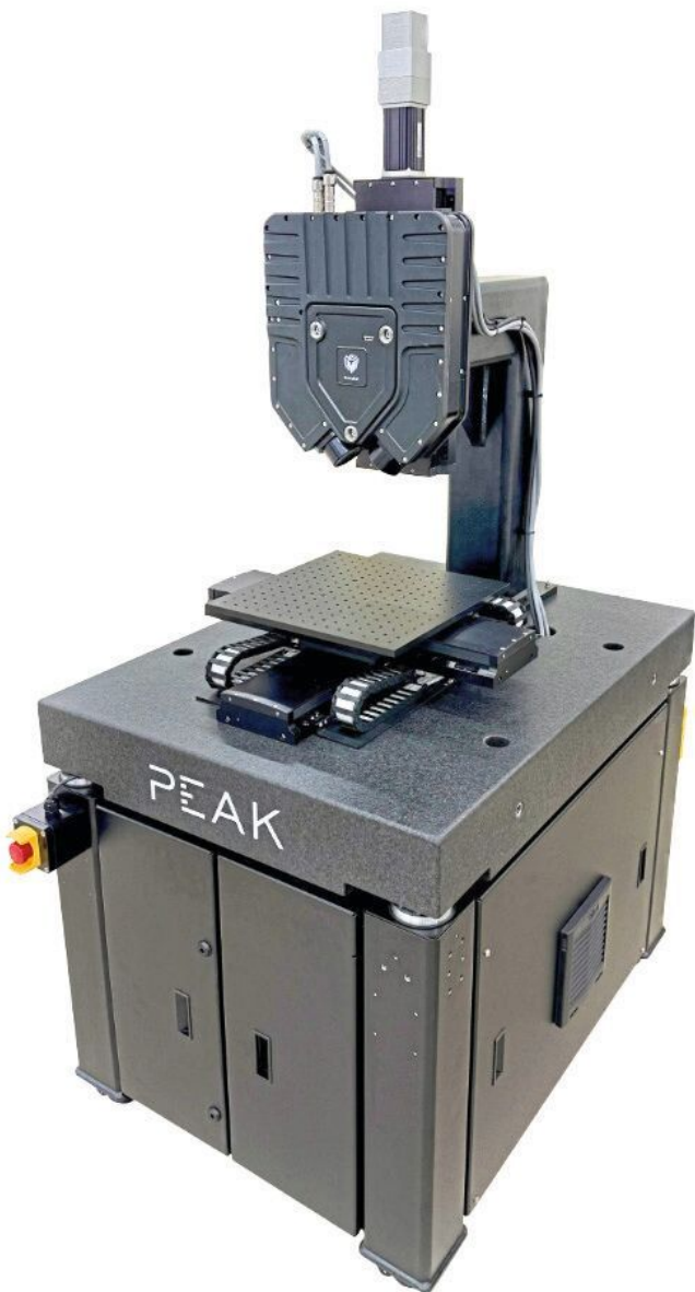
Der massive Granittisch eliminiert Vibrationen und ermöglicht so schwingungsfreie Messvorgänge. Die äußerst präzise Steuerung erlaubt die Positionierung von Objekten im Submikrometerbereich. (Bild: LMI und PEAK Metrology)
